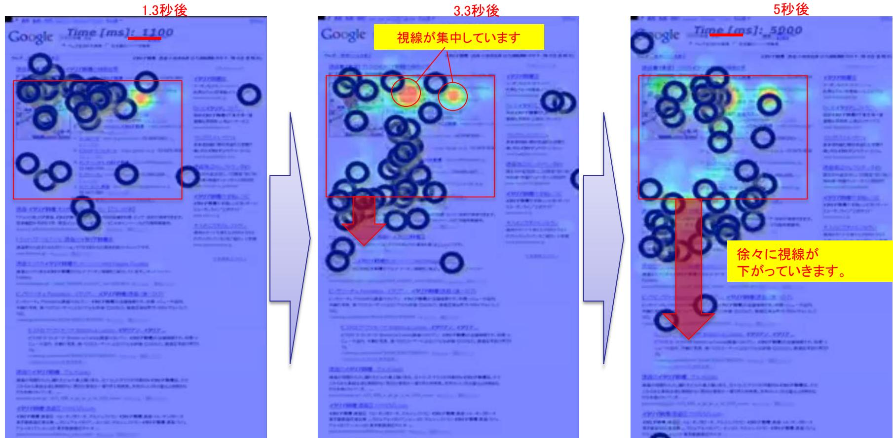
アイトラッキング機器で、赤外線を対象者の目の網膜に照射し、その反射を利用して画面上の目線の動きを測定した結果。
